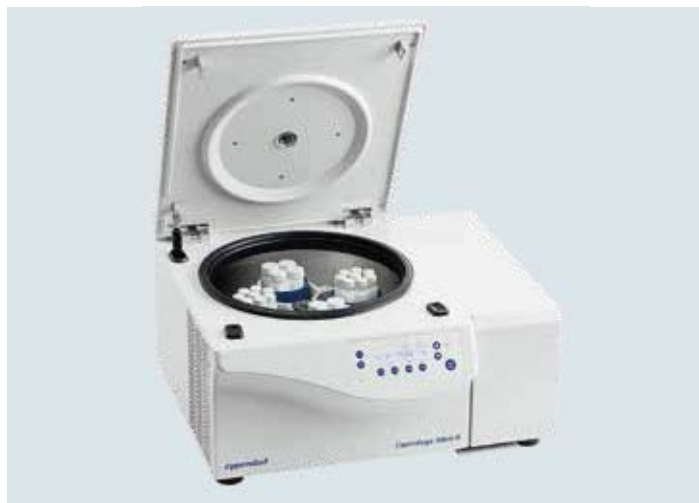
5804 R 离心机，适配水平转子 S-4-72 (4 × 250 mL)
