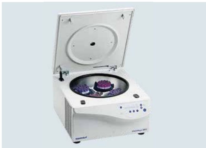
5810 离心机，适配水平转子 S-4-104 (4 × 750 mL)
